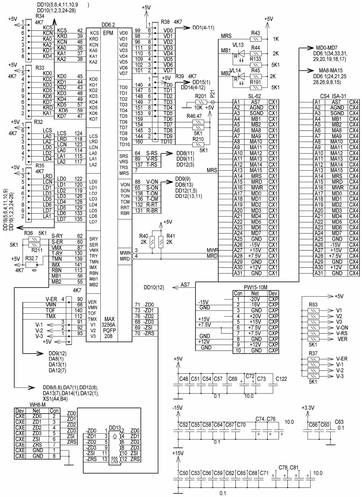
Рис. 2.11.5. Модуль CR07. Схема электрическая принципиальная. Лист 4
