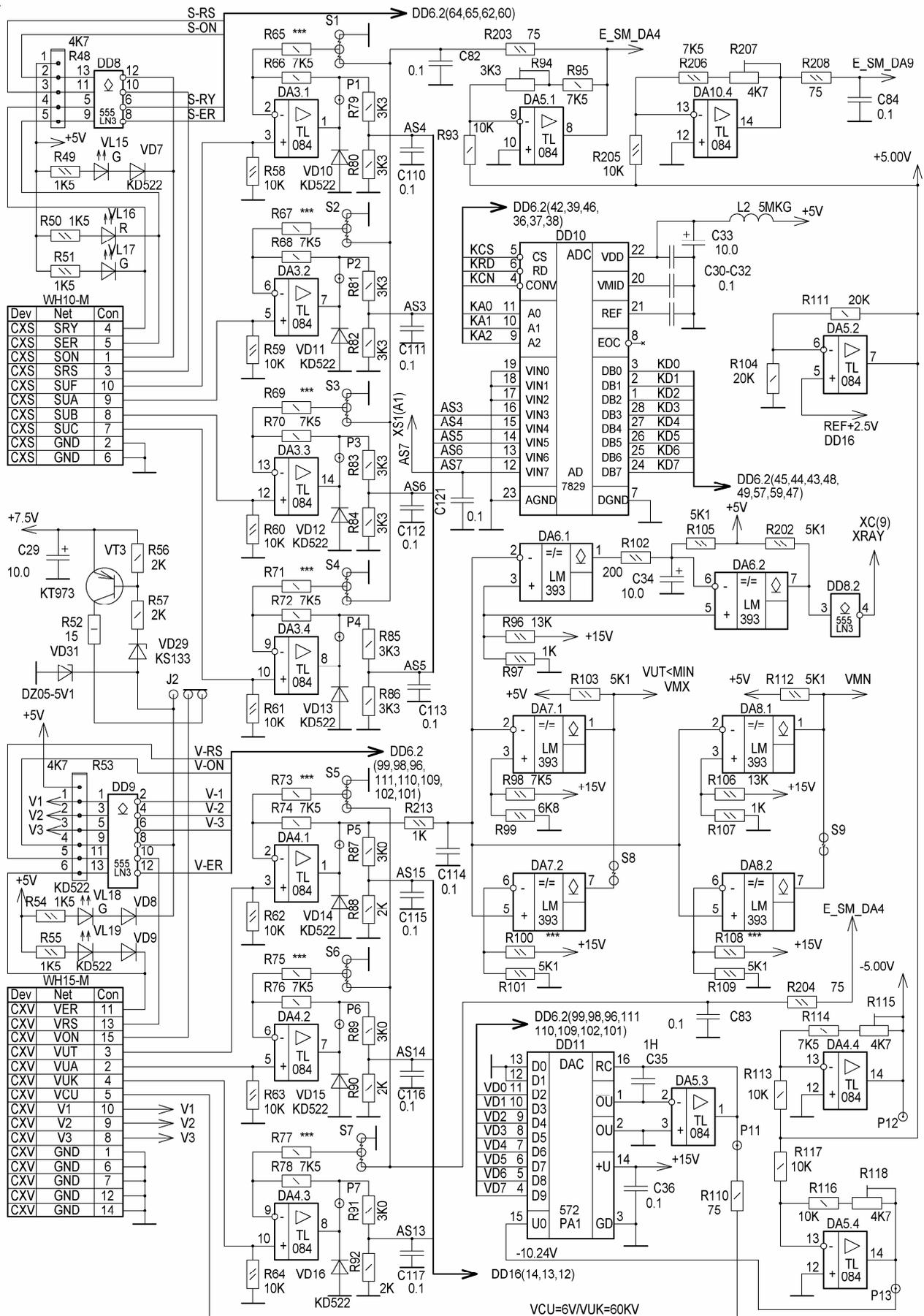
Рис. 2.11.5. Модуль CR07. Схема электрическая принципиальная. Лист 2
