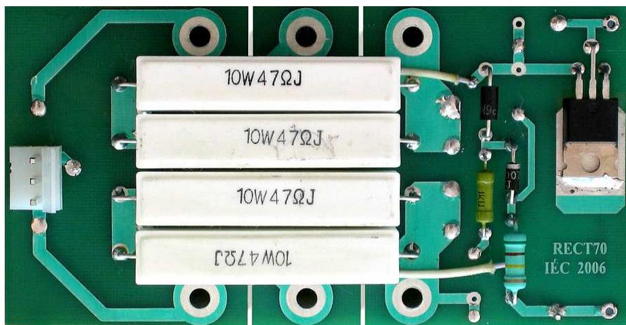
Рис. 2.14.1 Внешний вид блока REC70
