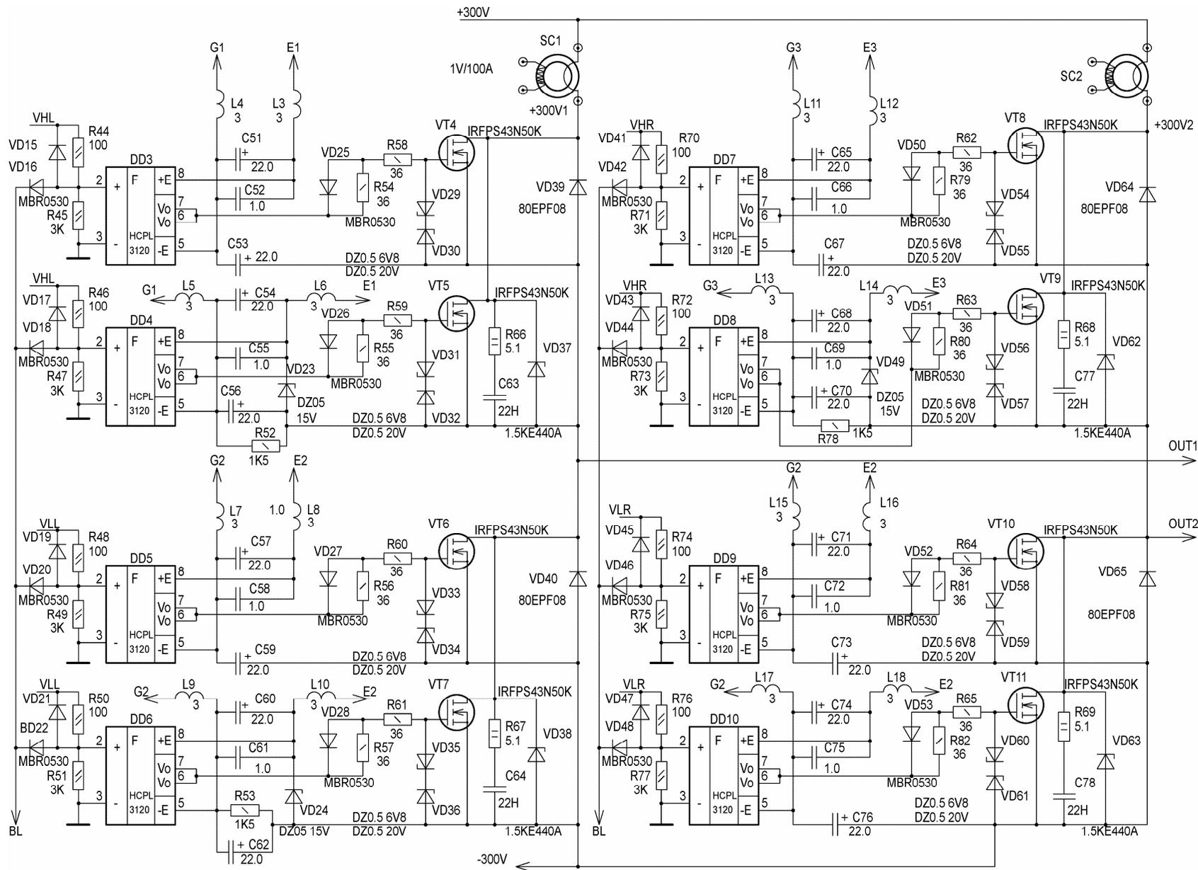
Рис. 2.5.5 Модуль PSU75. Схема электрическая принципиальная. Лист 2
