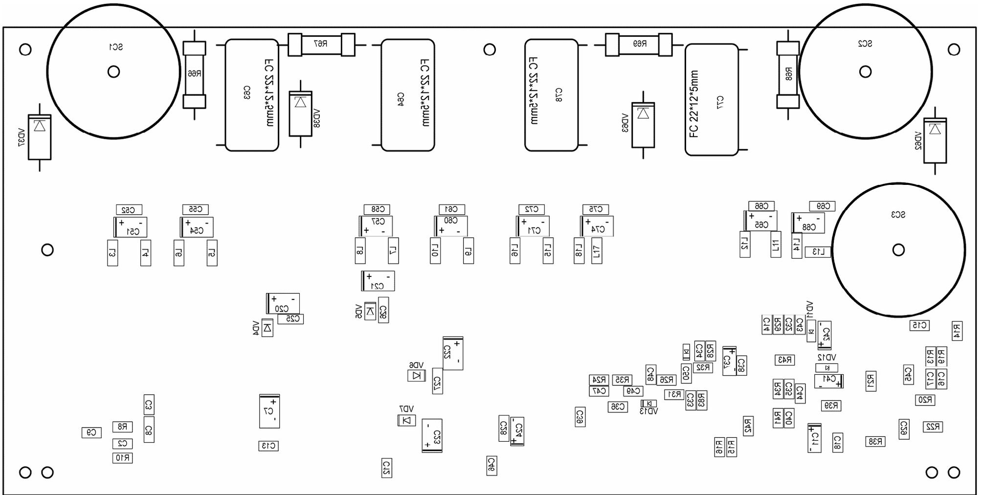
Рис. 2.5.6 Модуль PSU75. Схема расположения элементов. Вид снизу
