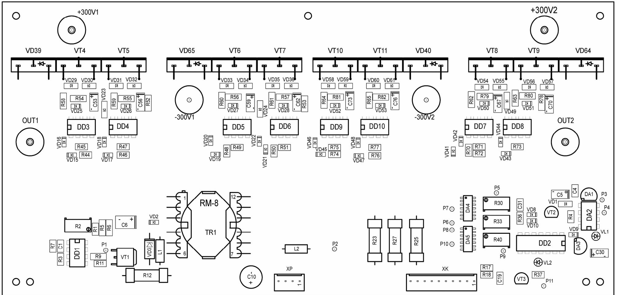
Рис. 2.5.6 Модуль PSU75. Схема расположения элементов. Вид сверху
