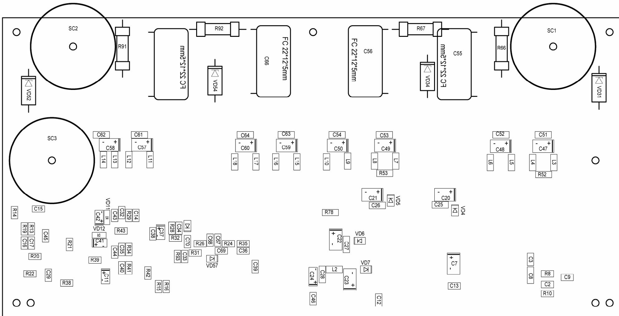
Рис. 2.5.4 Модуль PSU73. Схема расположения элементов. Вид снизу
