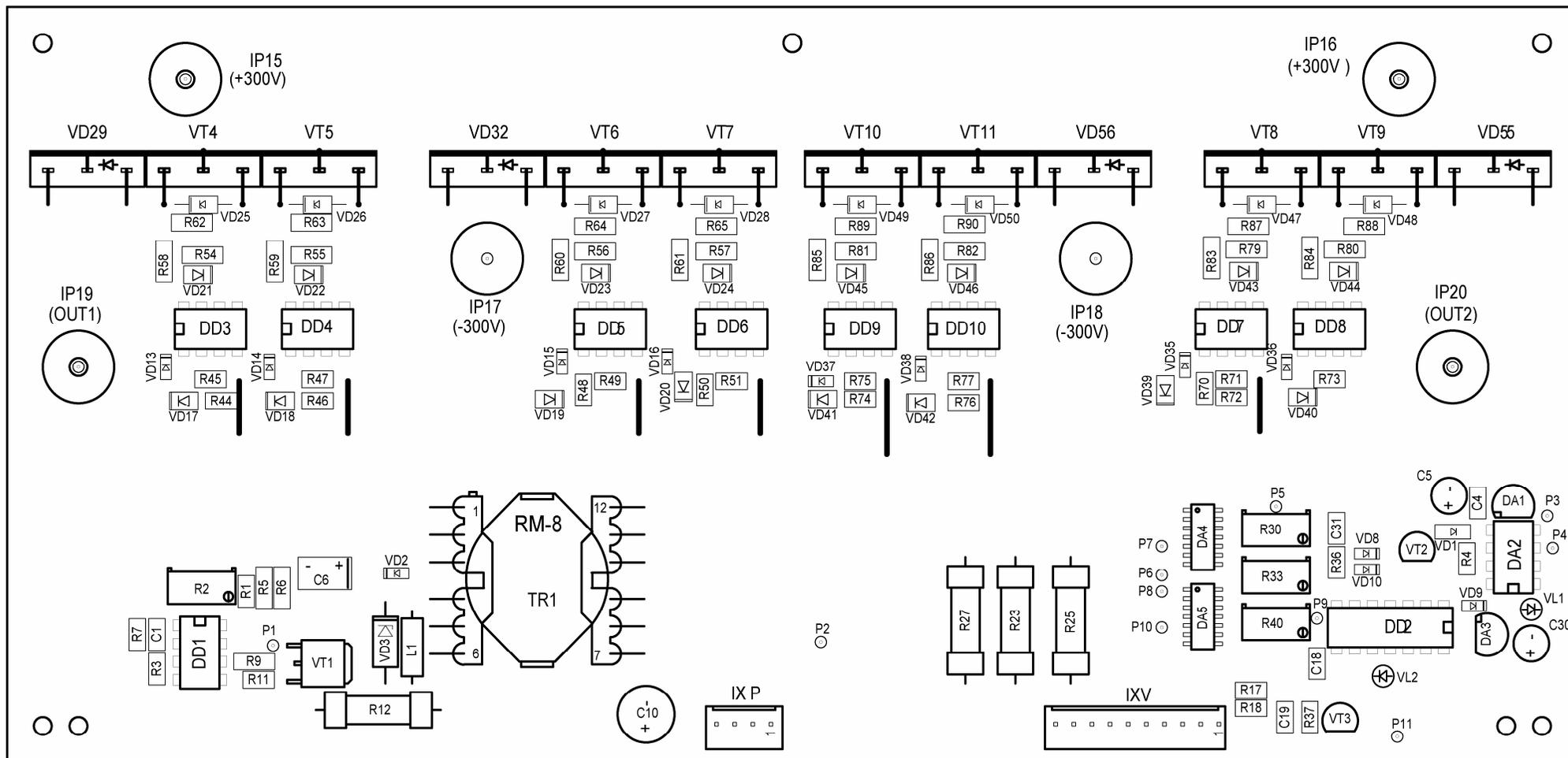
Рис. 2.5.4 Модуль PSU73. Схема расположения элементов. Вид сверху
