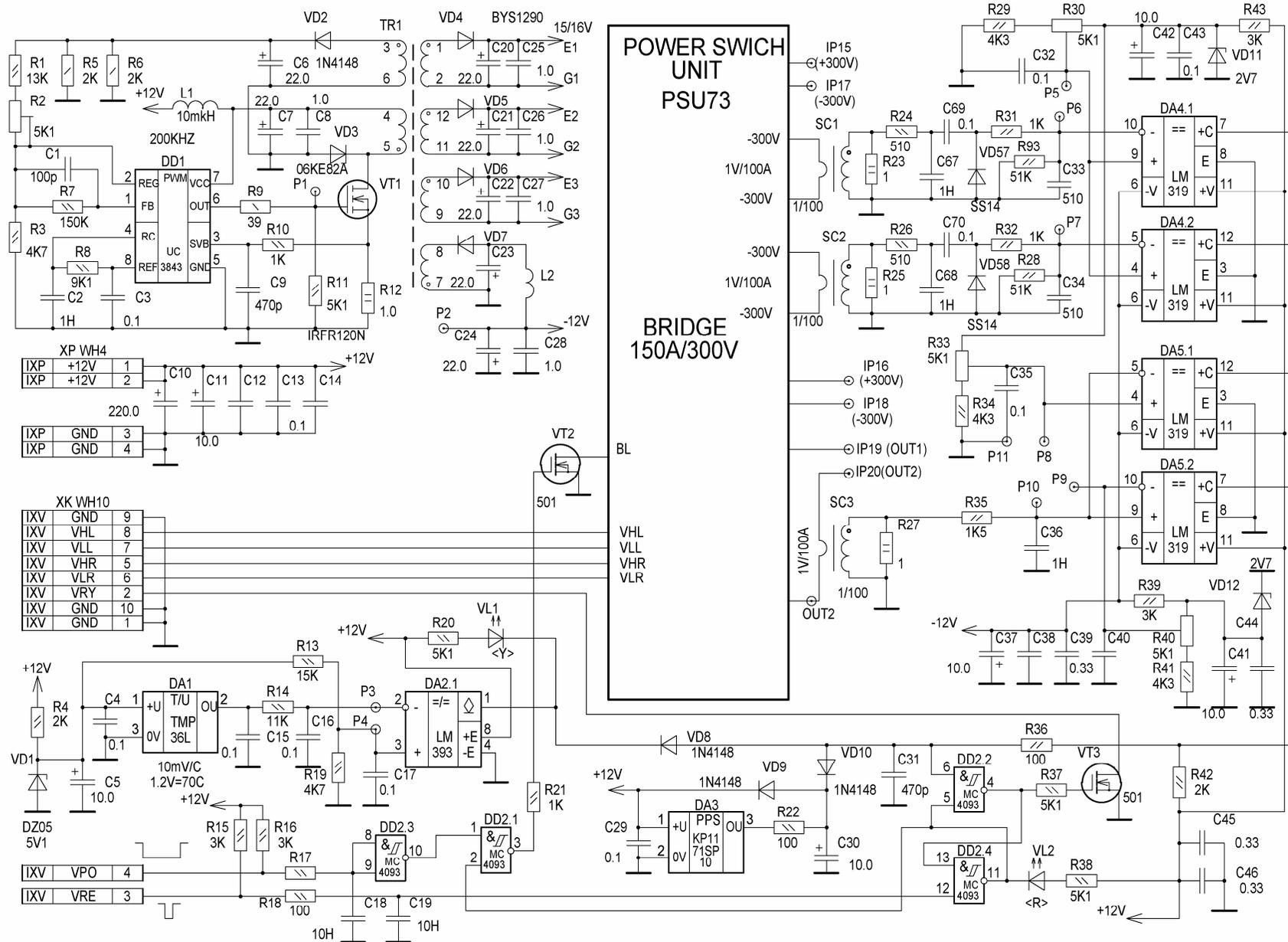
Рис. 2.5.3 Модуль PSU73. Схема электрическая принципиальная. Лист 1
